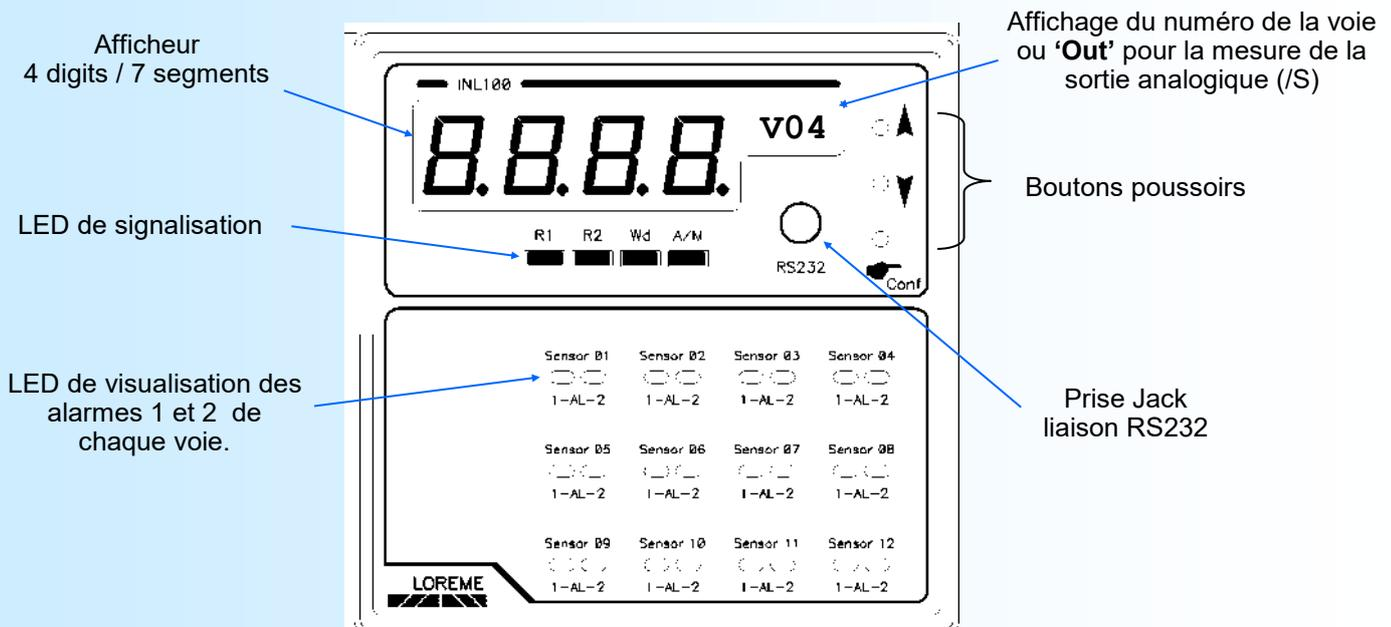
La face avant de l'appareil est composée de:
