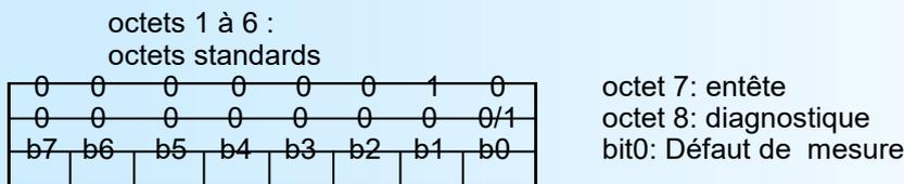
Le "défaut mesure" survient lorsque le slot de communication ne reçoit plus d'informations provenant de la partie mesure dans un délais de 3 s (c'est le cas si l'utilisateur est en train de configurer l'appareil par la liaison RS232).
