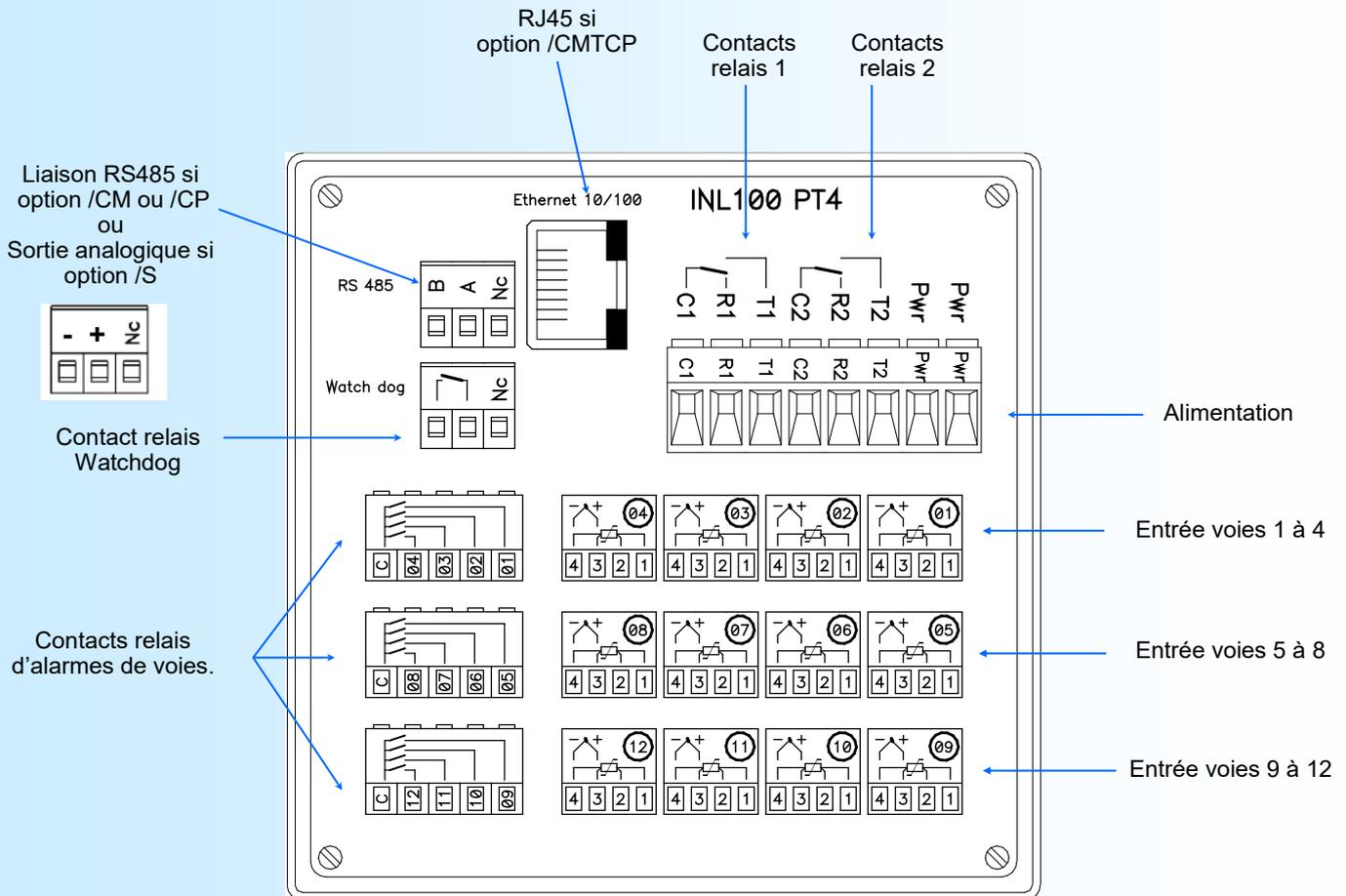
**SCHEMAS DE RACCORDEMENT INL100W**
